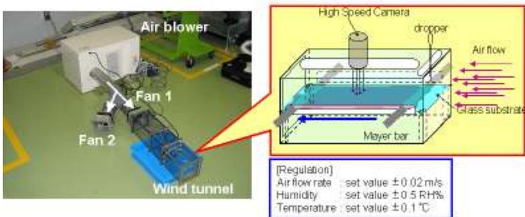
**Figure 2 Wind tunnel apparatus**
